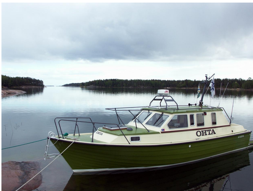
Ohtan ensimmäinen tutka JRC 1500 (2002 – 2012) oli tyypillinen pienen veneen pulssitutka. Ominaisuudet ovat vaatimatomat, mutta verrattomasti enemmän kuin ilman tutkaa. Edelleen ei tällaista tutkaa kannata halveksia – sumussa se voi olla kullan arvoinen
